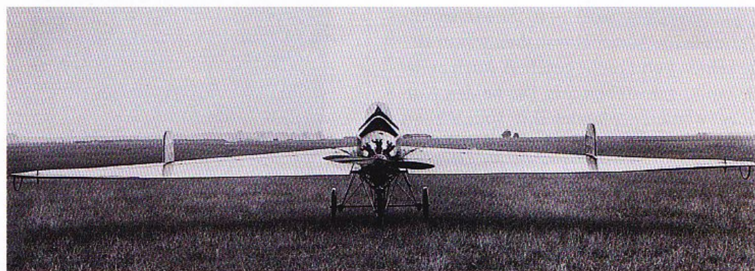
Die Perspektive trägt: Die A/3-Flügel haben keine Zuspitzung, sind aber stark geschränkt
